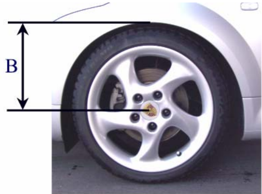
Abstandsmaß B - Radmitte - Kotflügelunterkante
