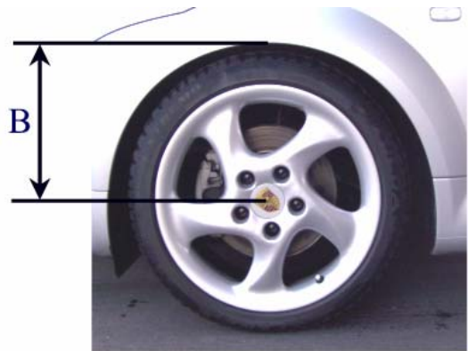
Abstandsmaß B - Radmitte - Kotflügelunterkante
