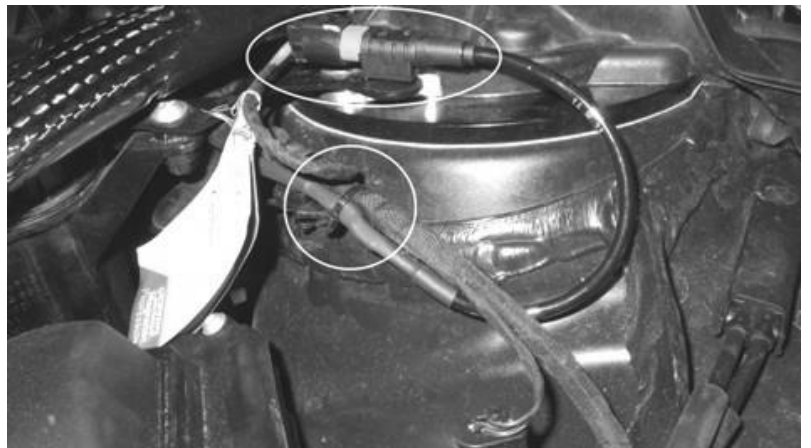
Das Kabel am Dom entlang nach oben führen./ Fit the cable along dome on top. Bild/pic 3
