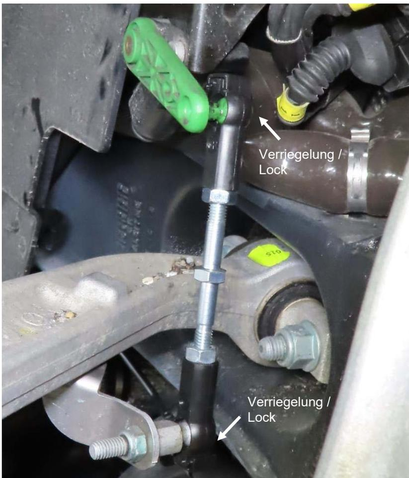
Mitgelieferte einstellbare Koppelstange montieren und verriegeln.
