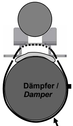
Kabelbinder / Cable ties
